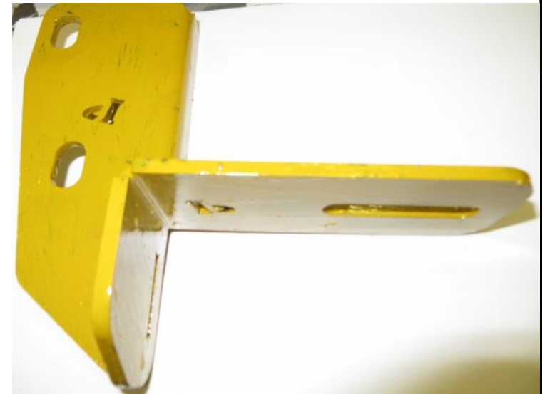
Bottom bracket marked (D) for drivers side.
